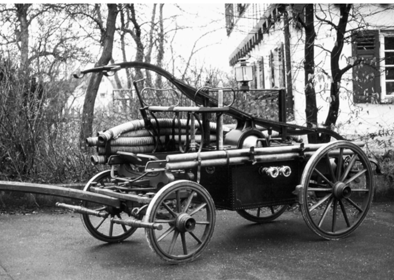
Saugfeuerspritze, beschafft 1886 von der Firma Heinrich Kurtz, Stuttgart, Fabrik-Nr. 1699.
